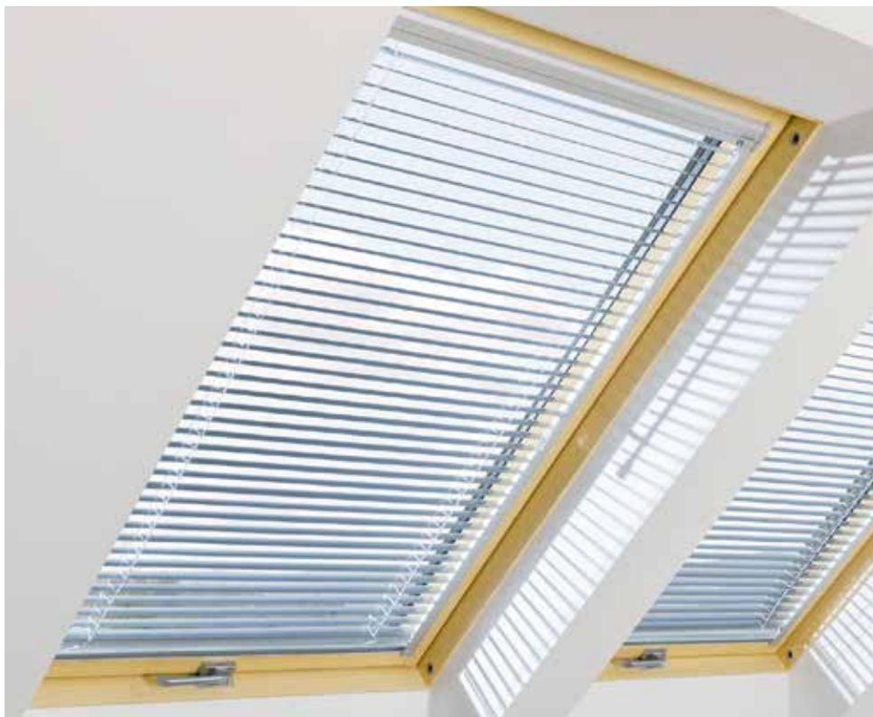
Благодаря наличию боковых направляющих, жалюзи AJP дают возможность лучше затемнить помещение, исключая провисание при малом угле наклона крыши. Позволяют регулировать поток света, поступающего в помещение, путем изменения наклона перьев. Оберегают от солнечного света, являясь декоративным элементом. Изготавливаются из алюминиевых полос, окрашиваемых в различные цвета.
