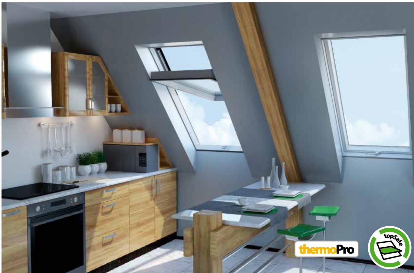
Окно изготовлено из многокамерного профиля ПВХ, усиленного оцинкованными стальными профилями. Подобная конструкция отличается высокой прочностью, стойкостью к коррозии и неблагоприятным атмосферным явлениям. Рекомендуется для установки в помещениях с повышенной влажностью. Створка при повороте от 0° до 45° поддерживается в открытом состоянии специальным механизмом. Створка для удобства мытья окна блокируется в положении 160°.
