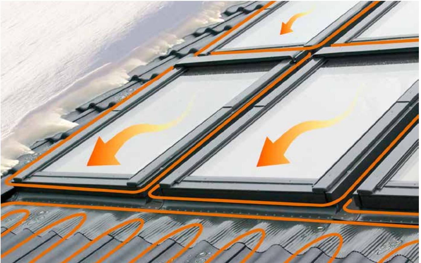
Мансардные окна с подогреваемым стеклопакетом и термокабелем – эксклюзивное предложение компании FAKRO, способное раз и навсегда избавить от необходимости регулярной очистки окон от снега и наледи. Эффективное плавление льда по всему периметру мансардного окна достигается благодаря возможности стеклопакета и кабеля нагреваться и повышать температуру примыкающих частей створки и оклада.
