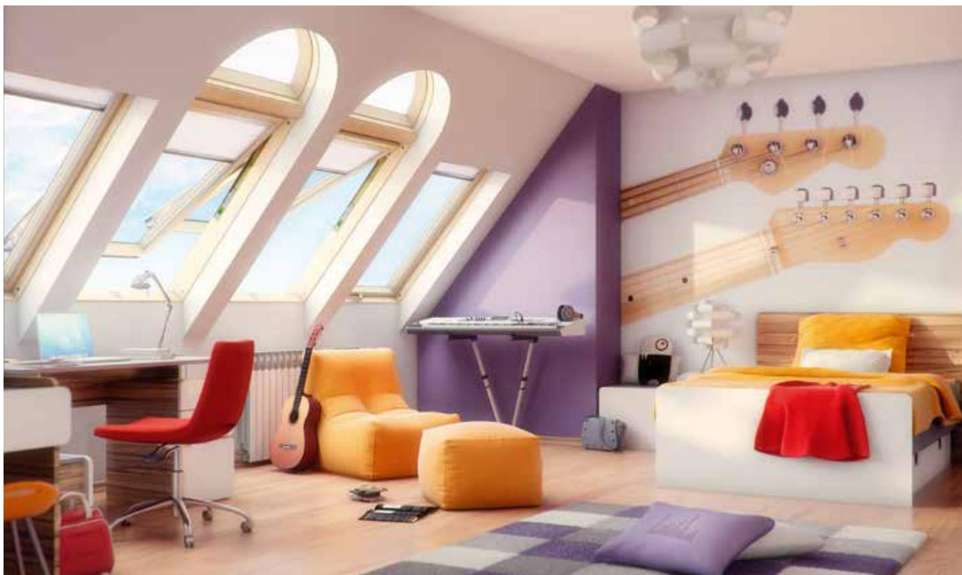
Надставка – это небольшое окно треугольной (FAP Z6), прямоугольной (ДУЭТ) или арочной формы (FBP Z6), устанавливаемое поверх стандартных открывающихся окон для крыши. Окна-надставки бывают только «глухого» типа (неоткрывающиеся).
