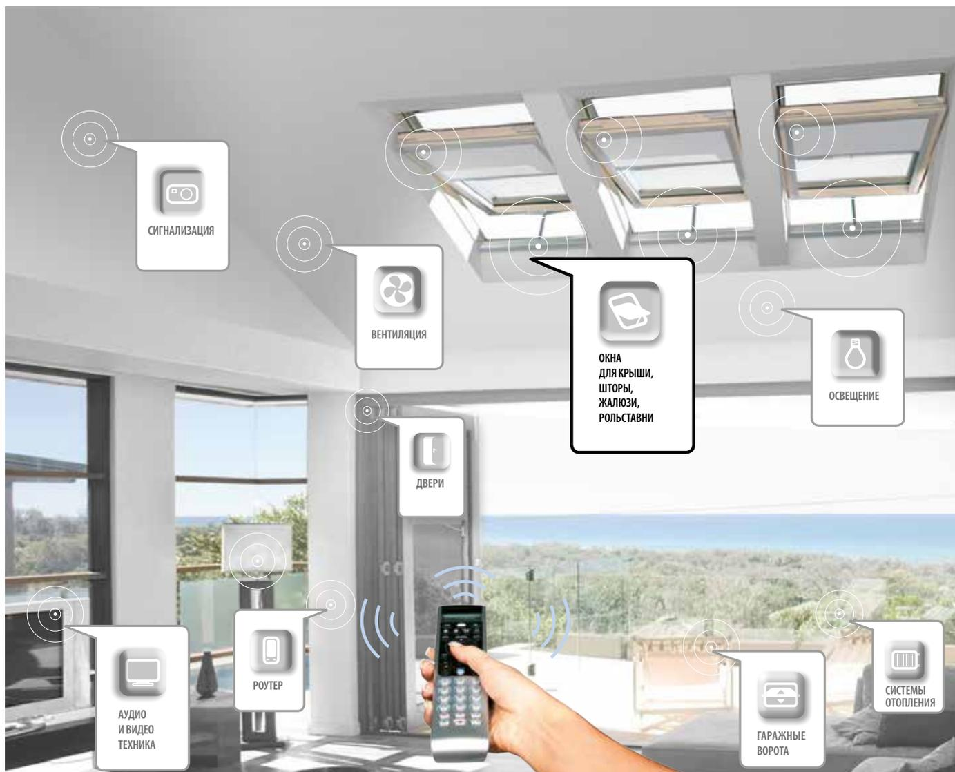
Автоматические окна FAKRO с использованием системы Z-Wave станут неотъемлемыми помощниками в Вашем доме. Z-Wave – это система беспроводной двусторонней связи, предназначенная для управления окнами и аксессуарами с помощью передачи радиосигнала по заданному маршруту. Система может объединять в одну сеть несколько окон и аксессуаров.
