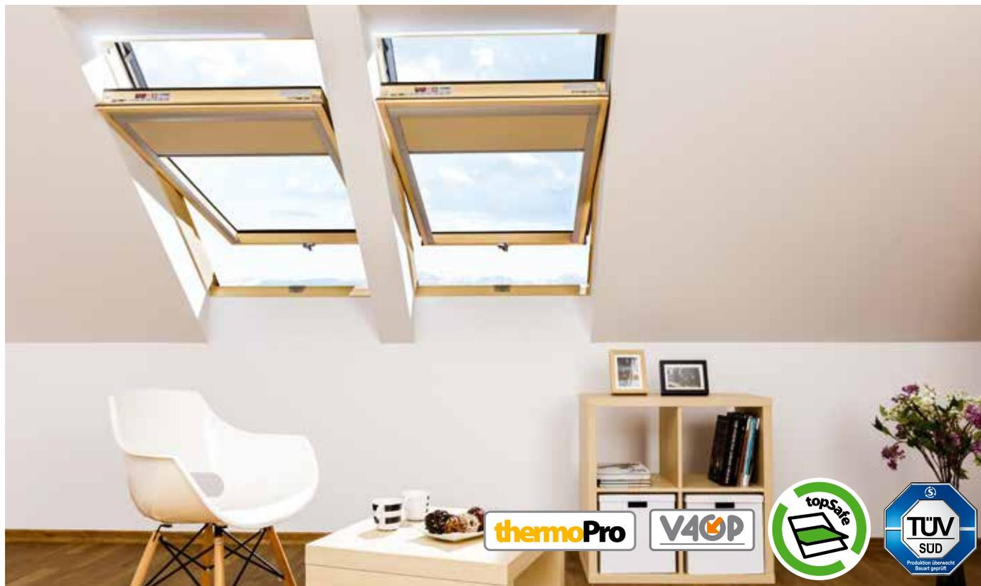
Модель FTP-V U3 – окно со среднеповоротным способом открывания, изготовленное с применением системы безопасности topSafe, которая обеспечивает дополнительную защиту от взлома. Окно оборудовано автоматическим антиконденсатным вентиляционным клапаном V40P и оснащено однокамерным энергосберегающим морозостойким стеклопакетом, в котором внешнее стекло – закаленное.
