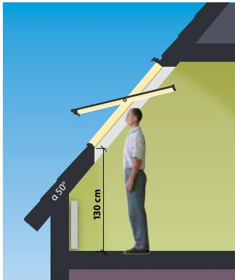
Окна со среднеповоротным способом открывания – самая популярная модель окон для крыши. Благодаря фрикционным петлям, расположенным в центральной части оконной рамы, створку окна можно поворачивать вокруг оси на 180° и фиксировать, что значительно облегчает процесс мытья внешнего стекла.
