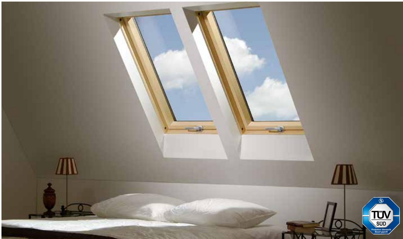
Модель окна FTS U2 со среднеповоротным открыванием – базовая модель окна для крыши. Благодаря фрикционным петлям, расположенным в центральной части оконной коробки, створку окна можно оставлять в позиции наклона, а также поворачивать вокруг оси на 180°, что делает удобным мытье внешнего стекла. Стальная конструкция поворотно-откидных петель с пластиковыми направляющими не только смягчает ход оконной створки, но и придает необходимую прочность и жесткость в условиях ветровых и снеговых нагрузок.
