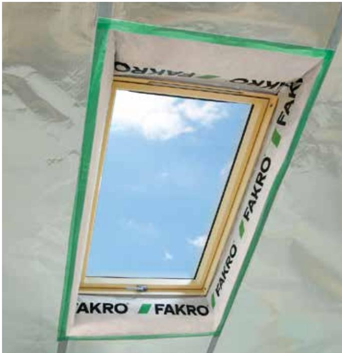
Оклад XDS соединяет пароизоляционный слой с коробкой окна и защищает теплоизоляцию в зоне окна для крыши от водяных паров. Известно, что для утеплителя губительно даже небольшое воздействие влаги и водяных паров. Поврежденная или неправильно выполненная пароизоляция ведет к намоканию утеплителя и его деформации, а тем самым к большим теплопотерям в мансарде. Прежде всего, это следует учитывать при монтаже окон для крыши, поскольку соединение окна с кровлей нуждается в полной герметичности.
