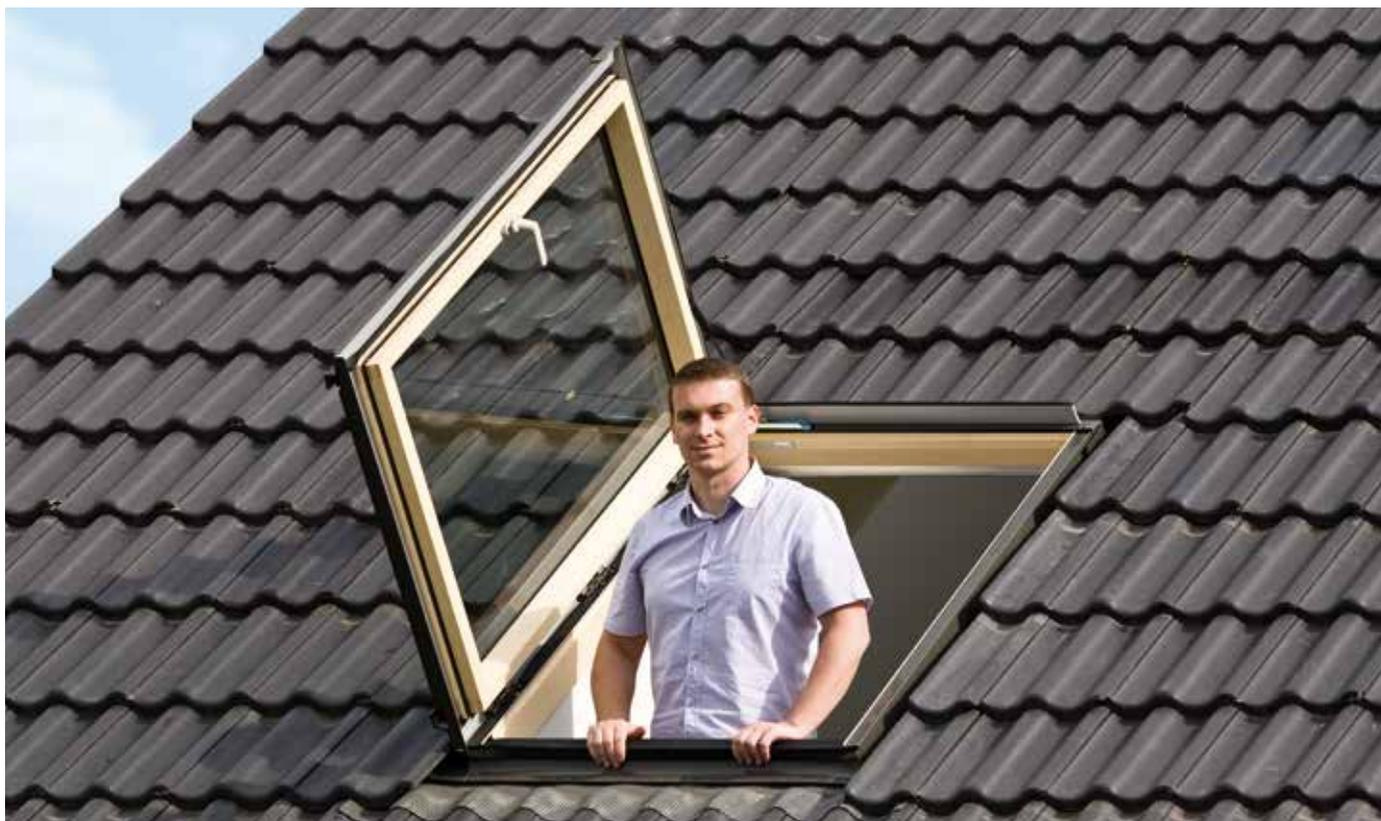
Распашное термоизоляционное окно – это окно для крыши с боковым способом открывания, предназначенное для установки в жилых отапливаемых помещениях. Окно может иметь правое FWL (ручка слева) или левое FWR (ручка справа) открывание. Створка открывается на угол до 90°. Установленный в верхней части окна газовый амортизатор облегчает открывание окна, удерживает створку в открытом положении, а также препятствует ее случайному захлопыванию.
