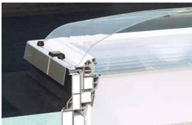
Окна изготовлены из многокамерного профиля ПВХ, заполненного внутри утеплителем, что повышает энергоэффективность окна. Имеет белый цвет со стороны помещения (RAL 9010). Материал, из которого изготавливаются окна, устойчив к воздействию кислот и спиртосодержащих жидкостей. Подходит для установки в помещениях с избыточной влажностью (бассейн, ванная и кухня).
