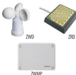
Модуль погоды **ZWMP** позволяет автоматически закрывать окна, взаимодействующие с системой Z-Wave, в случае изменения погодных условий. Сигналы об изменениях поступают от датчиков дождя ZRD и/или ветра ZWD, которые устанавливаются и приобретаются отдельно. Один датчик погоды позволяет обслуживать до 231 элемента по группам.
