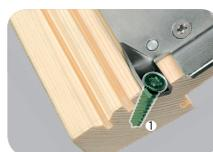
① Новый метод крепления оконных петель: применение усиленных саморезов большего диаметра, вкрученных под углом в деревянный элемент створки, предотвращает вырывание петель и возможность выдавливания створки.
