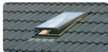
**Окно-люк WGI** с крышкой, оснащенной стеклопакетом с двумя закаленными стеклами, что обеспечивает защиту от несанкционированного проникновения. Оборудовано газовым амортизатором и открывается по верхним петлям на угол до 120°.
