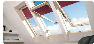
**FYP-V U3 proSky** – эксклюзивное окно для крыши с высотой до 206 см, обеспечивающее широкий обзор и дополнительное освещение. Приподнятая ось поворота створки позволяет за счет высоты окна увеличить полезную площадь остекления, и при этом устанавливать данные окна в кровле со стандартным межстропильным шагом, не требуя трудоемких работ по его изменению. Створка фиксируется под углом 160°.
