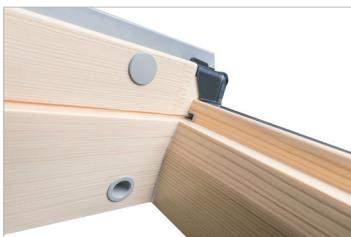
С 2016 года в окнах FAKRO введены важные технические улучшения – специальные каналы, отводящие конденсат, образующийся в результате недостаточной вентиляции или избыточной влажности в помещении. Также выводят капиллярную влагу в период таяния снега. Данное решение – надежная защита от конденсата и возможных капиллярных протечек в случаях, когда окно не освобождается от снега.
